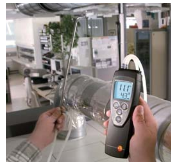
Измерение скорости потока отработанного воздуха
