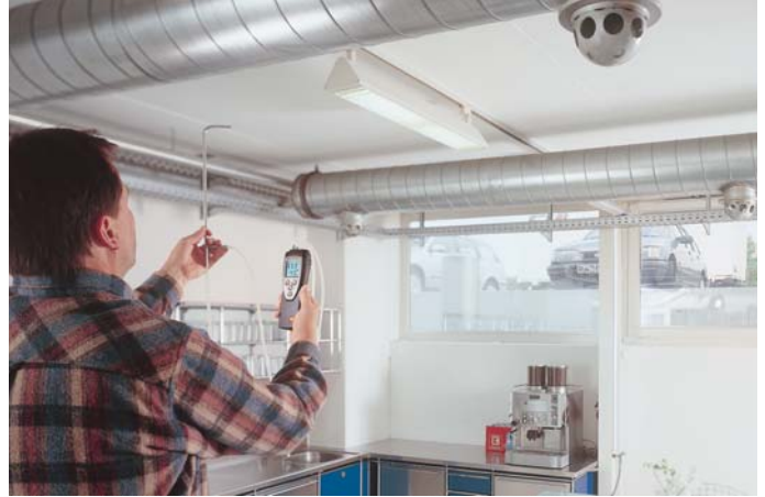
Измерения скорости воздуха в воздуховодах
