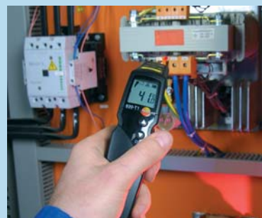
Измерительная точка диаметром 2 мм (testo 830-T3)
