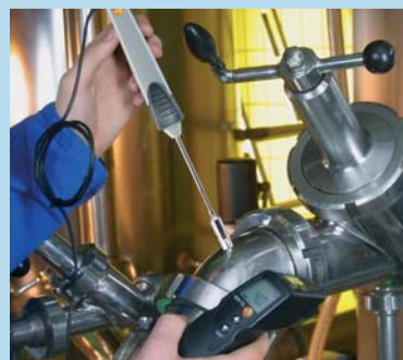
Подсоединение дополнительных внешних зондов температуры (testo 830-T2/T3)
