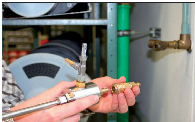
Подключение измерительной камеры и защитного фильтра к зонду остаточной влажности testo 6615
