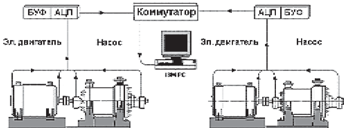
Рис. 3. Блок-схема стационарной системы, предназначенной для работы на значительном удалении от объекта диагностирования:
