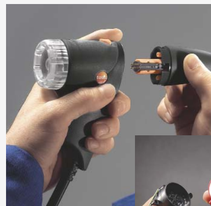
Замена трубки зонда
