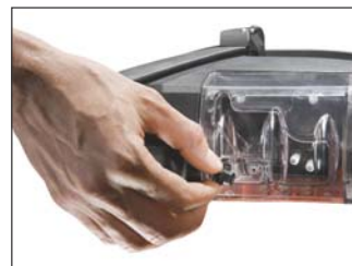
Режим непрерывной откачки конденсата для продолжительных измерений
