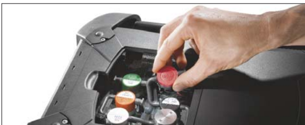
«Подключи и работай»: чрезвычайно простая технология замены сенсоров газа Конденсатосборник: очистка конденсатосборника осуществляется легко и быстро
