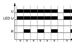
Включение напряжения питания U, начинает отсчёт установленного времени T. После отсчёта времени, наступает срабатывание исполнительного реле R и снова начинается отсчёт времени T. Циклическая работа реле длится до момента выключения напряжения питания U.
