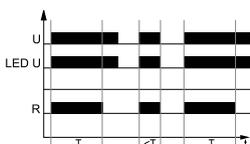
При включении напряжения питания U, сразу срабатывает исполнительное реле R и начинается отсчёт установленного времени T. После отсчёта времени T, исполнительное реле R возвращается в исходное состояние.
