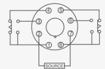
Принципиальная электрическая схема DH48S-2Z
