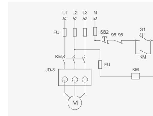
Схема подключения цепи к сети AC 380 В
