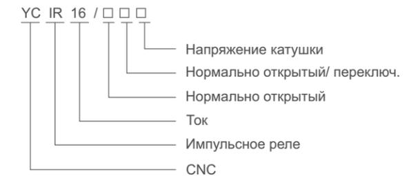
Например, YCIR-16/10 DC12V — реле 1NO для постоянного тока 16 А, 12 В
