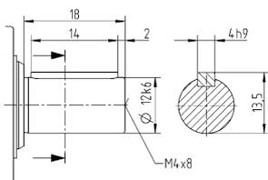
Размеры без установленных допусков — номинальные размеры
