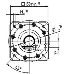
Диаметр вала двигателя [мм]
