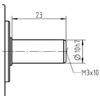
Размеры без установленных допусков — номинальные размеры
