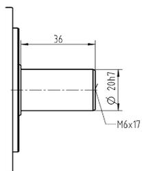
Съемный выходной фланец типа B5
