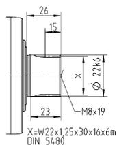
Размеры без установленных допусков — номинальные размеры
