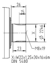
Размеры без установленных допусков — номинальные размеры
