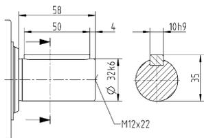
Размеры без установленных допусков — номинальные размеры
