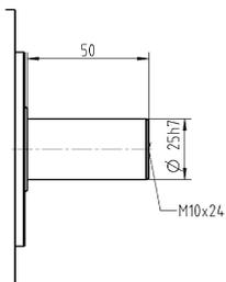
Размеры без установленных допусков — номинальные размеры
