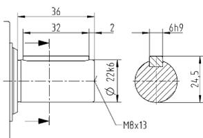
Размеры без установленных допусков — номинальные размеры
