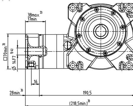
Диаметр вала двигателя [мм]
