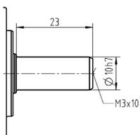
Размеры без установленных допусков — номинальные размеры
