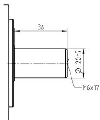
Съемный выходной фланец типа B5
