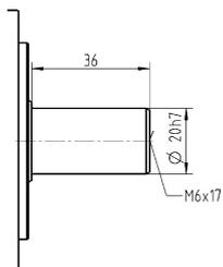
Размеры без установленных допусков — номинальные размеры
