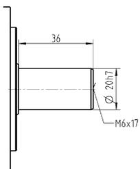
Съемный выходной фланец типа B5
