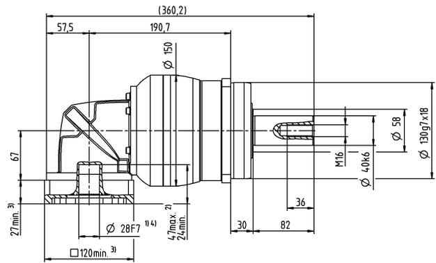
Диаметр вала двигателя [mm]
