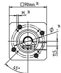
Диаметр вала двигателя [мм]
