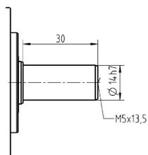
Съемный выходной фланец типа B5
