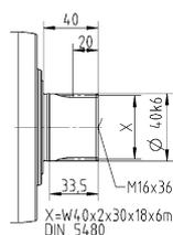
Размеры без установленных допусков — номинальные размеры
