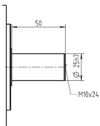
Размеры без установленных допусков — номинальные размеры
