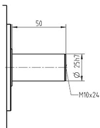
Съемный выходной фланец типа B5
