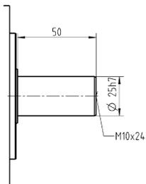
Съемный выходной фланец типа B5
