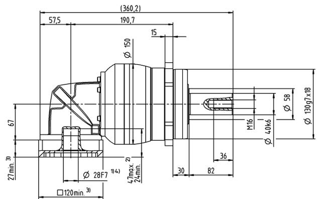
Диаметр вала двигателя [мм]
