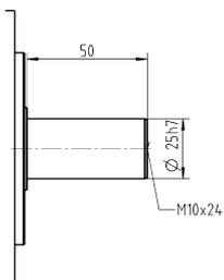
Размеры без установленных допусков — номинальные размеры
