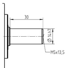
Съемный выходной фланец типа B5
