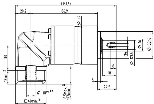
Диаметр вала двигателя [mm]
