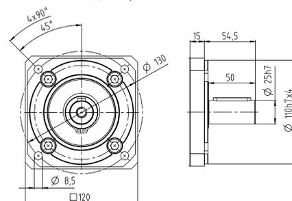
Размеры без установленных допусков — номинальные размеры
