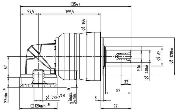
Диаметр вала двигателя [mm]
