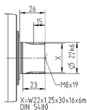
Размеры без установленных допусков — номинальные размеры
