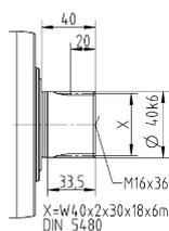
Размеры без установленных допусков — номинальные размеры
