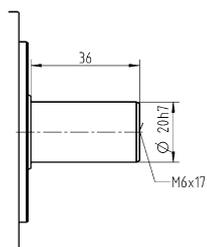
Съемный выходной фланец типа B5
