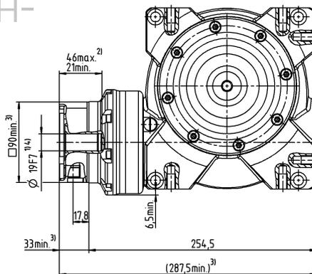
Диаметр вала двигателя [мм]
