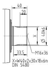
Размеры без установленных допусков — номинальные размеры
