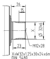
Размеры без установленных допусков — номинальные размеры
