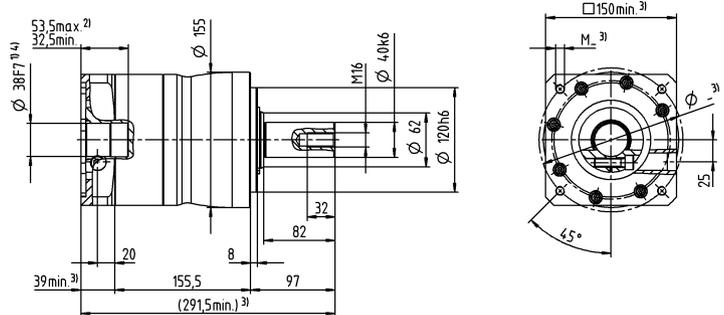
Диаметр вала двигателя [мм]
