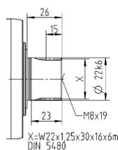
Размеры без установленных допусков — номинальные размеры
