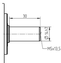
Съемный выходной фланец типа B5
