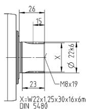
Размеры без установленных допусков — номинальные размеры
