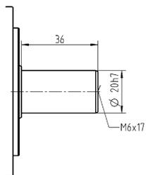
Размеры без установленных допусков — номинальные размеры
