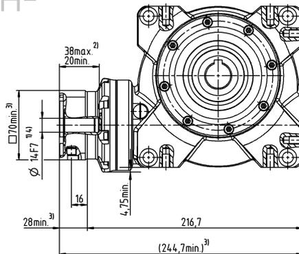
Диаметр вала двигателя [мм]
