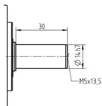
Съемный выходной фланец типа B5
