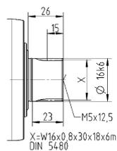
Размеры без установленных допусков — номинальные размеры
