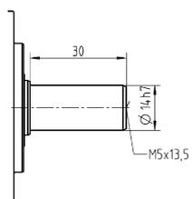
Размеры без установленных допусков — номинальные размеры
