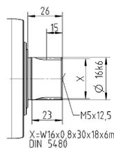
Размеры без установленных допусков — номинальные размеры
