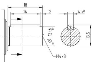
Размеры без установленных допусков — номинальные размеры
