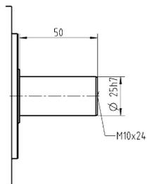
Съемный выходной фланец типа B5
