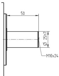
Съемный выходной фланец типа B5
