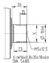
Размеры без установленных допусков — номинальные размеры
