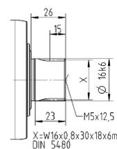
Размеры без установленных допусков — номинальные размеры
