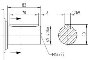
Размеры без установленных допусков — номинальные размеры
