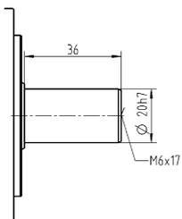
Размеры без установленных допусков — номинальные размеры
