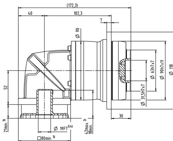
Размеры без установленных допусков — номинальные размеры
