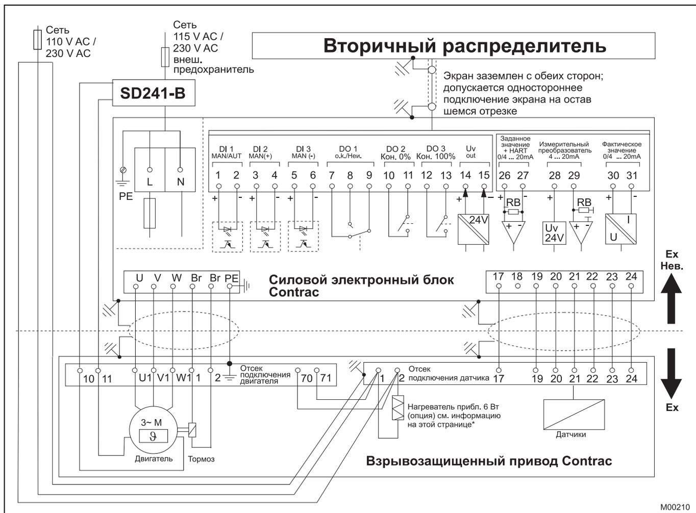
Рис. 4: электрическое подключение: взрывозащищенный привод аналоговый / двоичный
