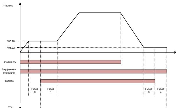
Рис. 6-15. Логическая схема управления тормозом
