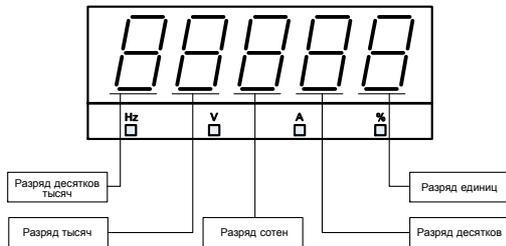
Рис. 5-1. Индикация на 5-значном светодиодном (цифровом) дисплее
