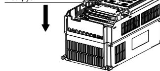
Рисунок В-2. Установка модуля выгрузки и загрузки
