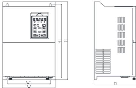
Рис. 2-6. Схема настенного монтажа ПЧ мощностью 30~160 кВт
