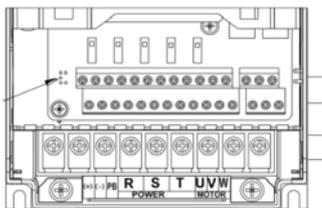
Рис. 3-11. Схема силовых клемм ПЧ мощностью 4~5,5 кВт
