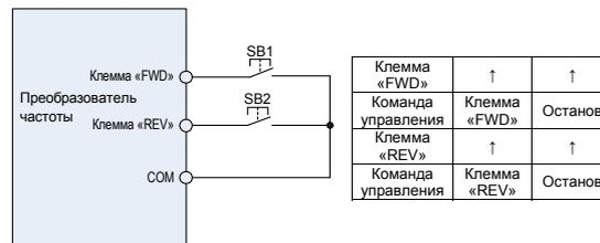
Рисунок 6-12. Схема импульсного управления остановом
