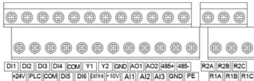
Рис. 3-15. Клеммы цепи управления
