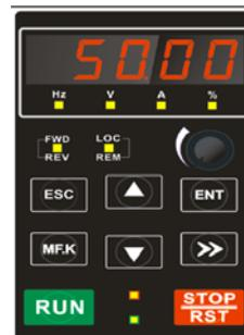
Рисунок 7. Внешний вид и рабочая область панели управления
