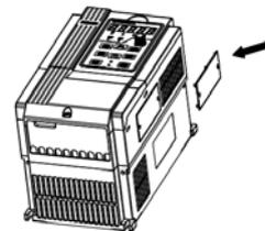
Рис. 3-8. Демонтаж и монтаж пылезащитного кожуха
