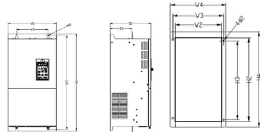
Рис. 2-8. Схема фланцевого монтажа ПЧ мощностью 30~90 кВт
