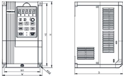
Рис. 2-5. Схема настенного монтажа ПЧ мощностью 4~22 кВт
