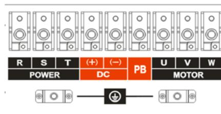
Рис. 3-14. Схема силовых клемм ПЧ мощностью 45~90 кВт
