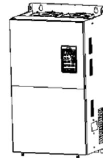
Рис. 2-4. Схематическое изображение ПЧ мощностью 30~160 кВт
