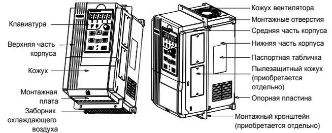
Рис. 2-3-б. Схематическое изображение ПЧ мощностью 4~22 кВт
