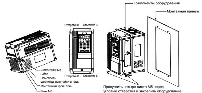
Рис. 3-6. Настенный монтаж ПЧ мощностью 4~22 кВт
