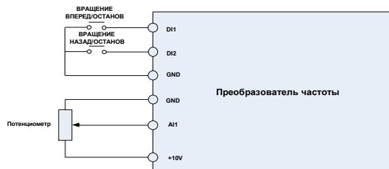
Рисунок 4. Схема подключения цепи управления
