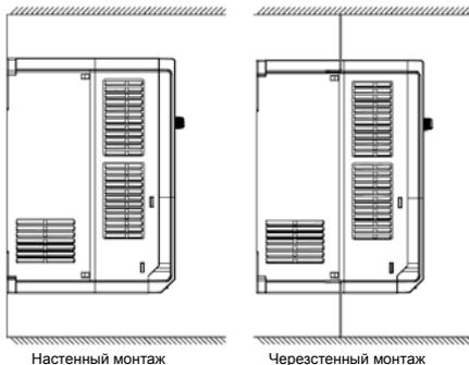
Рис. 3-1. Способы монтажа
