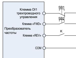
Рисунок 6-11. Настройки режима трехпроводного управления 2
