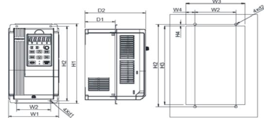
Рис. 2-7. Схема фланцевого монтажа ПЧ мощностью 4~22 кВт
