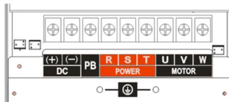
Рис. 3-13. Схема силовых клемм ПЧ мощностью 30~37 кВт
