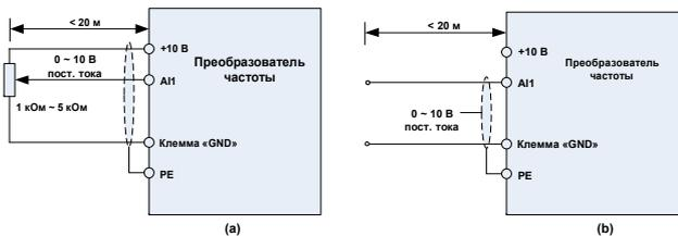
Рис. 3-16. Схема электропроводки клеммы аналогового входа
