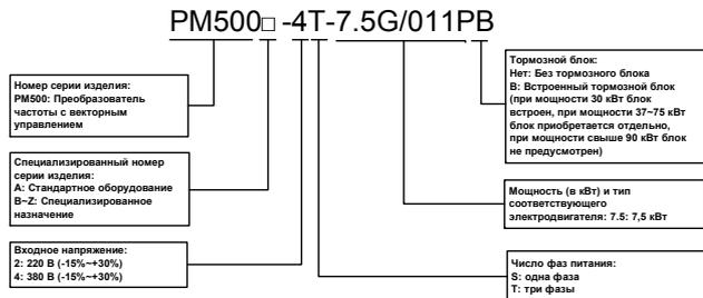
Рис. 2-1. Расшифровка номера модели
