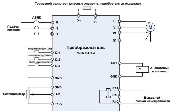
Рисунок 6. Схема подключения
