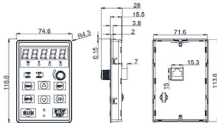
Рис. 2-9. Габаритный чертеж клавиатуры ПЧ мощностью 4,0–160 кВт
