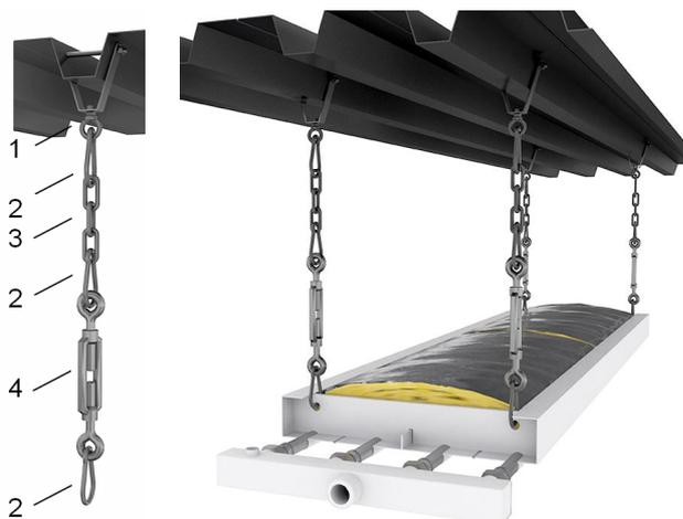
1 – трапециевидная подвеска с соединительным болтом; 2 – карабин; 3 – цепь звеньевая или трос; 4 – талреп (стяжная муфта).
