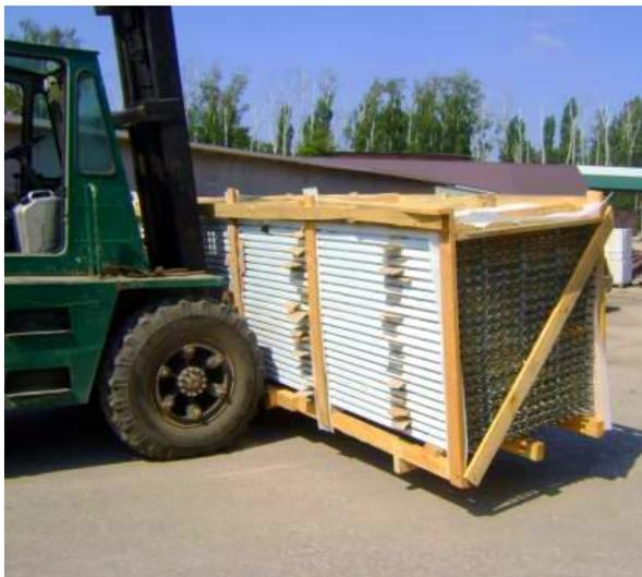
Упаковки и деревянные ящики с потолочными отопительными панелями “ТЕПЛОПАНЕЛЬ” должны разгружаться по одной упаковке, приподнимая их нижнюю часть с помощью подъемника, или каждая панель должна разгружаться, по отдельности, вручную. В случае несоблюдения вышеуказанного, компания-производитель не несет ответственности за ущерб, который может быть причинен материалу во время операций по разгрузке.
