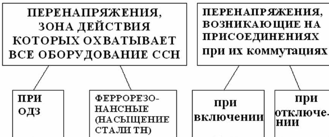
**Рис.1. Классификация внутренних перенапряжений в сетях 6 - 35 кВ**
