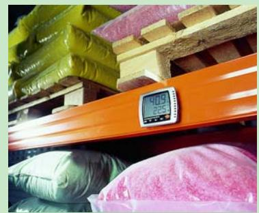
Точный мониторинг условий хранения на складах с погрешностью ±2% ОВ
