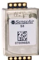
SenseAir® S8 Представляет собой миниатюрный сенсор концентрации углекислого газа. Прибор может быть использован для контроля за состоянием вентиляции или включения тревожной сигнализации. Сенсор может быть встроен в разнообразные приборы сигнализирования, где требуется мониторинг уровня CO<sub>2</sub>, например, для обнаружения утечек.
