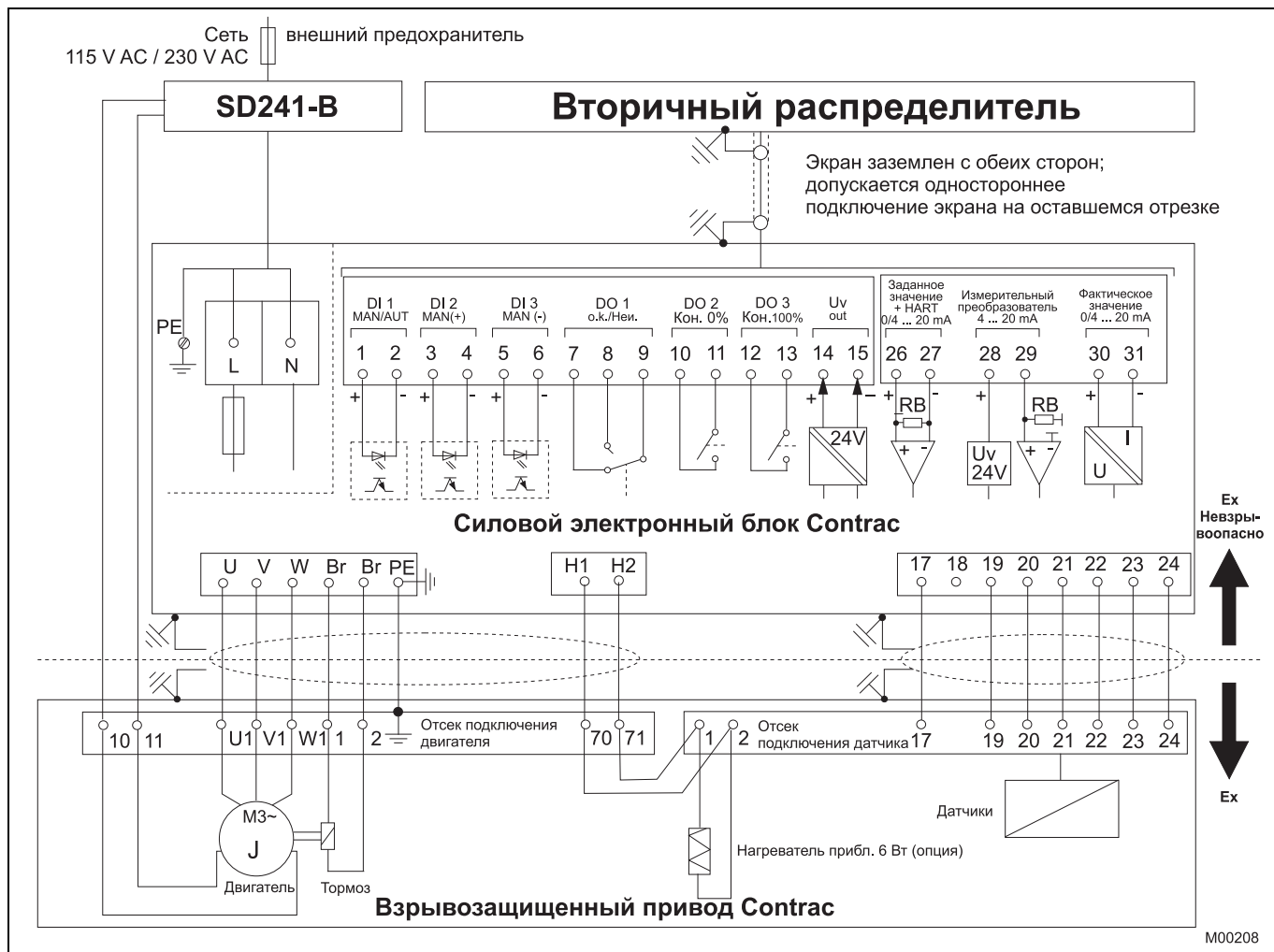
Рис. 2: электрическое подключение: взрывозащищенный привод аналоговый / двоичный
