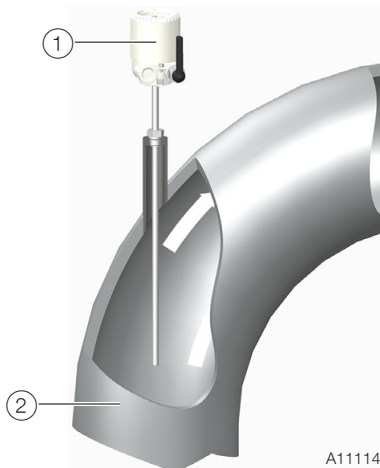
Fig. 5 ① SensyTemp TSP300-W ② Processing pipe
