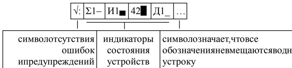
Рисунок 2.7. Пример статусной строки при отсутствии ошибок и предупреждений.
