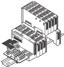
Модули дистанционного управления (RMC) обеспечивают управление множественными релейными выходами для включения/выключения контакторов для каждой из цепей обогрева. Контроль за датчиками температуры осуществляется модулями дистанционного контроля (RMM), в то время как управление цепями обогрева осуществляется модулем UIT.
