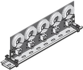
Трансформатор тока nVent RAYCHEM является важной частью системы NGC-30. Модули nVent RAYCHEM CRM в сочетании с этим трансформатором тока предоставляют ряд дополнительных функций, включая контроль и сигнализацию тока утечки на землю, а также возможность контролировать и сигнализировать высокую и низкую силу тока в цепях обогрева. При возникновении высоких токов утечки на землю контроллер может отключить цепи обогрева, в которых возникла утечка.
