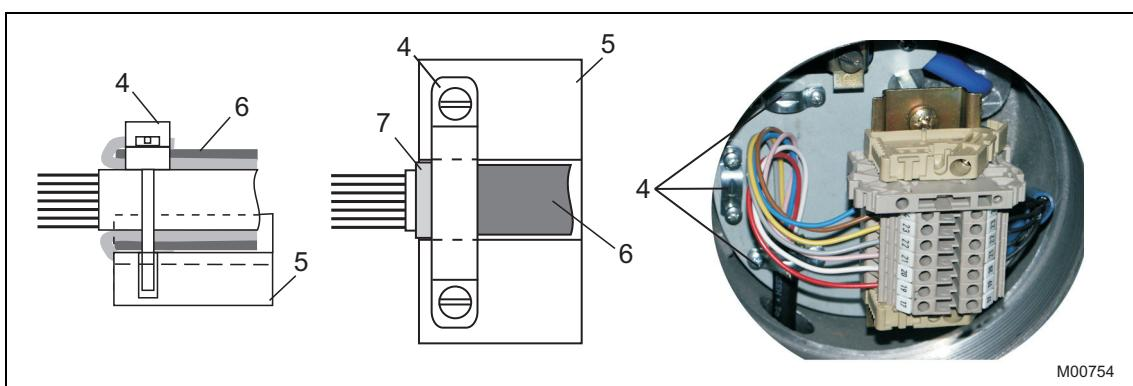
Рис. 11: Размещение экрана кабеля
