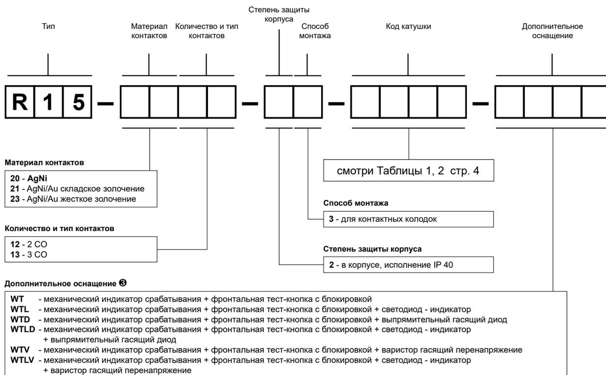
④ **WT** - стандартное оснащение реле для контактных колодок. **WTD, WTLD** - только для катушек DC. **WTV, WTLV** - только для катушек AC
