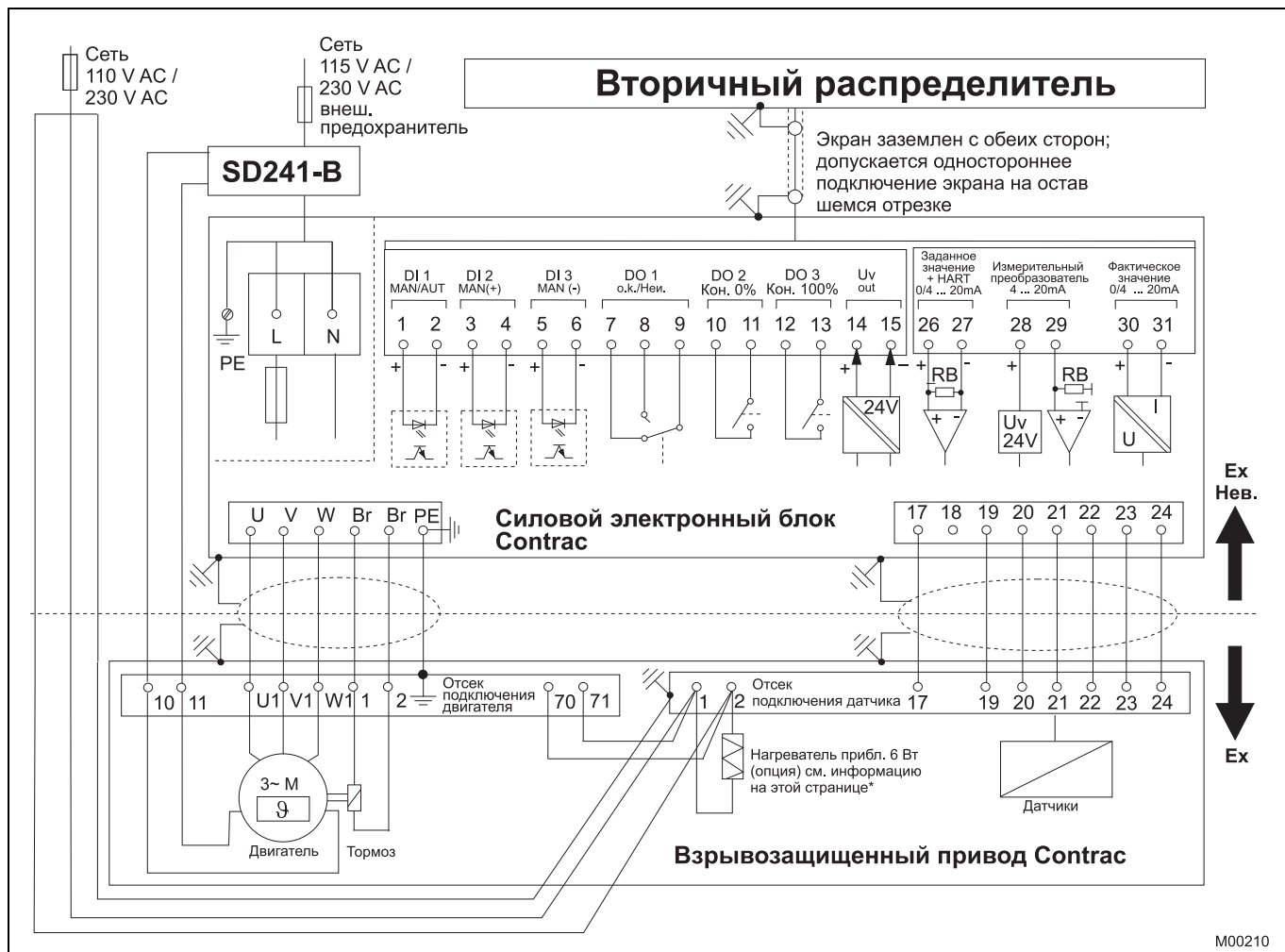
Рис. 2: электрическое подключение: взрывозащищенный привод аналоговый / двоичный
