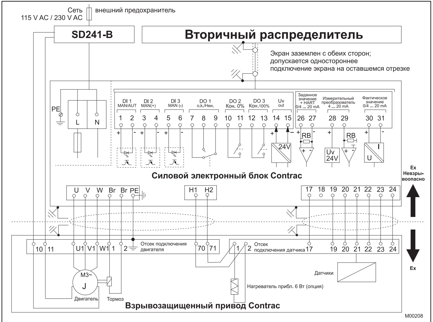
Рис. 2: электрическое подключение: взрывозащищенный привод аналоговый / двоичный
