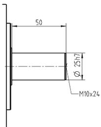
Съемный выходной фланец типа B5
