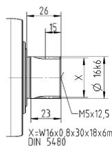
Размеры без установленных допусков — номинальные размеры
