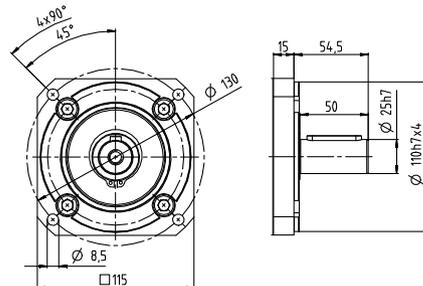
Размеры без установленных допусков — номинальные размеры
