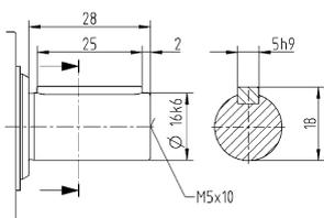
Размеры без установленных допусков — номинальные размеры
