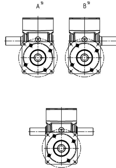
С двухсторонним выходным валом в качестве опции. Чертежи по запросу. Шлицевой выходной вал не доступен для данной модели.
