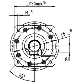
Размеры без установленных допусков — номинальные размеры
