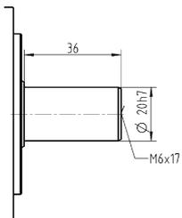
Съемный выходной фланец типа B5
