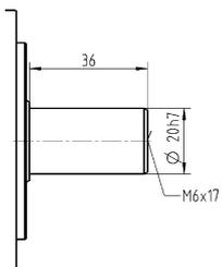
Размеры без установленных допусков — номинальные размеры
