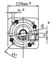
Диаметр вала двигателя [мм]
