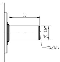
Съемный выходной фланец типа B5
