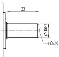
Размеры без установленных допусков — номинальные размеры
