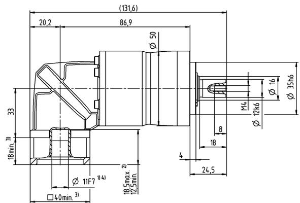
Диаметр вала двигателя [mm]
