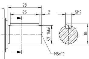
Размеры без установленных допусков — номинальные размеры
