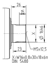
Размеры без установленных допусков — номинальные размеры
