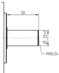
Размеры без установленных допусков — номинальные размеры
