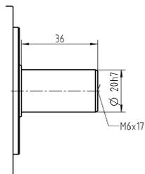
Съемный выходной фланец типа B5
