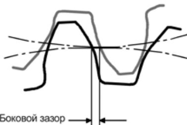
Измерение производится при заблокированном входном вале.
