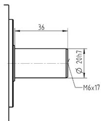
Съемный выходной фланец типа B5
