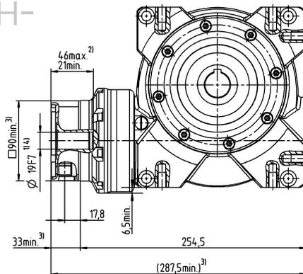
Диаметр вала двигателя [мм]
