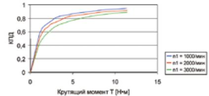
Показатели КПД редуктора, указываемые WITTENSTEIN alpha, всегда относятся к режиму работы при полной нагрузке. При низкой мощности на входе или низком крутящем моменте КПД, обусловленный остающимся постоянным крутящим моментом холостого хода, меньше. При этом мощность на покрытие потерь не повышается. На высоких оборотах также будет более низкий КПД (см. рисунок).
