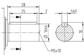
Размеры без установленных допусков — номинальные размеры
