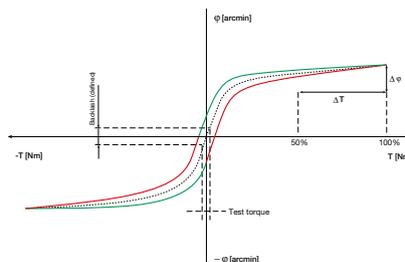
При заблокированном входном валу на выход редуктора в обоих направлениях подается постепенно возрастающий до определенной величины и потом снижающийся крутящий момент. Регистрируется зависимость угла кручения от величины крутящего момента. В результате получается замкнутая кривая, из которой можно определить → **угловой люфт** и → **жесткость на кручение**.
