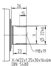
Размеры без установленных допусков — номинальные размеры
