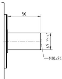
Размеры без установленных допусков — номинальные размеры
