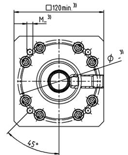
Диаметр вала двигателя [мм]
