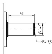
Размеры без установленных допусков — номинальные размеры
