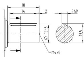
Размеры без установленных допусков — номинальные размеры
