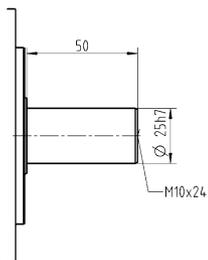
Съемный выходной фланец типа B5
