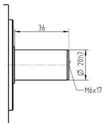
Размеры без установленных допусков — номинальные размеры
