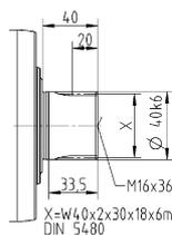
Размеры без установленных допусков — номинальные размеры
