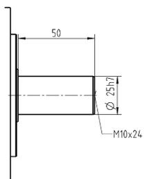
Размеры без установленных допусков — номинальные размеры
