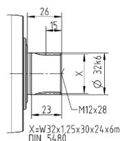
Размеры без установленных допусков — номинальные размеры
