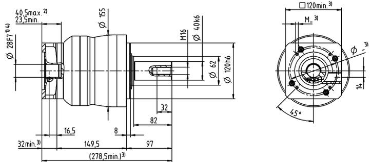
Диаметр вала двигателя [мм]
