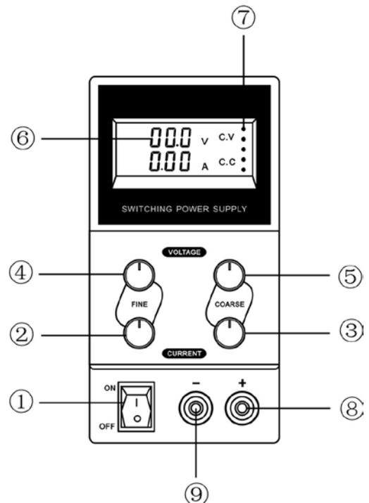
9) Выходной отрицательный терминал
