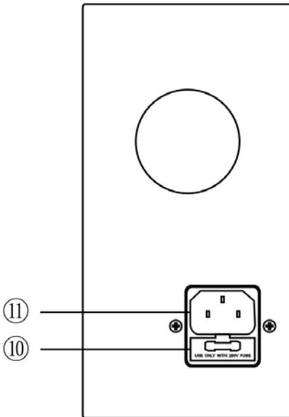
10) Предохранитель: 110В:5А 220В:3А
