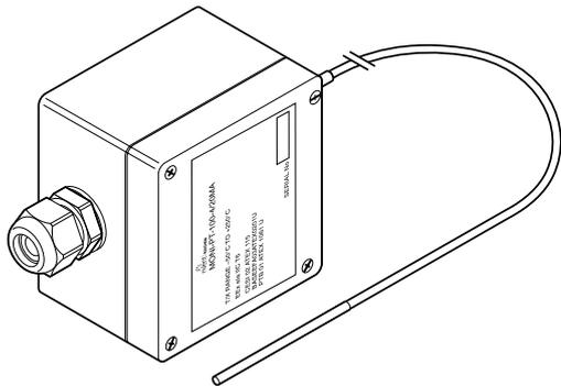
Датчик nVent RAYCHEM Pt 100, подключенный к трансмиттеру на 4–20 мА, в соединительной коробке из армированного стекловолокном полиэфиром с кабельным сальником M20 (голубой).
