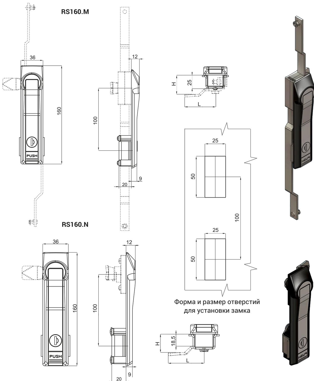
Форма и размер отверстий для установки замка
