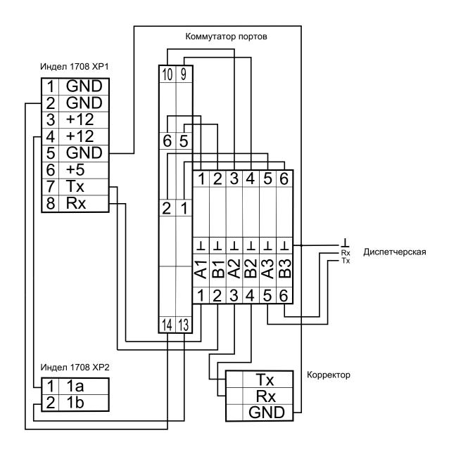
Коммутатор портов представляет собой реле (12В) и набор клемных колодок. Диспетчерская имеет постоянное подключение к интерфесу RS-232 корректора. При звонке Индел-1708 перекоммутирут связь с корректором на себя, чем отключит диспетчерскую. После опроса связь диспетчерской и RS-232 корректора восстановится.
