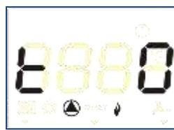
Работа в режиме „Трубочист” с минимальной мощностью
