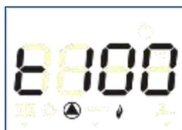
Работа в режиме „Трубочист” с максимальной мощностью
