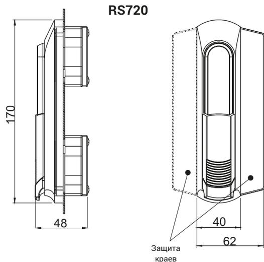
Форма и размер отверстий для установки замка
