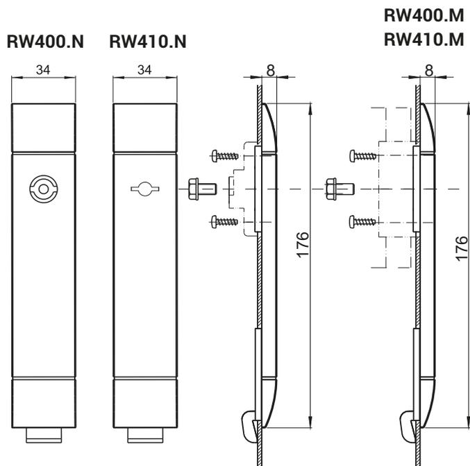
Форма и размер отверстий для установки замка
