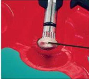
Посадка с натягом обеспечивает надежную фиксацию цапфы в корпусе
