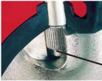
Посадка с натягом обеспечивает надежную фиксацию оси в диске
