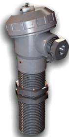
Датчики контроля минимальной скорости, серии **ДКМС1-1551** **ДКМС2-1551** предназначены для контроля минимальной скорости ленты конвейера в пределах номинальных скоростей от 0,4 до 10м/с.
