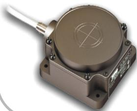
Емкостные датчики контроля схода ленты, серии **ДКСЛ-37ХХ**, предназначены для контроля аварийного схода конвейерной ленты в сторону. Датчики могут применяться на всех типах ленточных конвейеров. Монтируются по одному с каждой стороны конвейера, под конвейерной лентой, на границе её допустимого положения. Выход ленты из чувствительной зоны датчиков (или вход в чувствительную зону) вызывает изменение их логического сигнала. Они предназначены для работы во взрывобезопасной среде.
