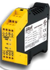
Реле безопасности для контроля кнопок аварийного останова, выключателей безопасности. С реле безопасности с управляемыми контактами, 2 НО-контакта + 1 НЗ-контакт. Запуск/перезапуск ручной контролируется с **AD SRE4C**. Вход обратной связи EDM для контроля внешних контакторов. Обе модели можно использовать для устройств с категорией безопасности до 4 согласно **ГОСТ Р ИСО 13849-1-2003**
