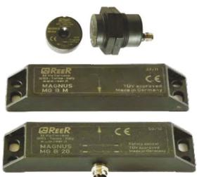
Серия **MAGNUS** - кодируемые магнитные бесконтактные выключатели на основе герконов. Используются в целях обеспечения безопасности для контроля открытия-закрытия механических ограждений, препятствующих прохождению посторонних лиц.
