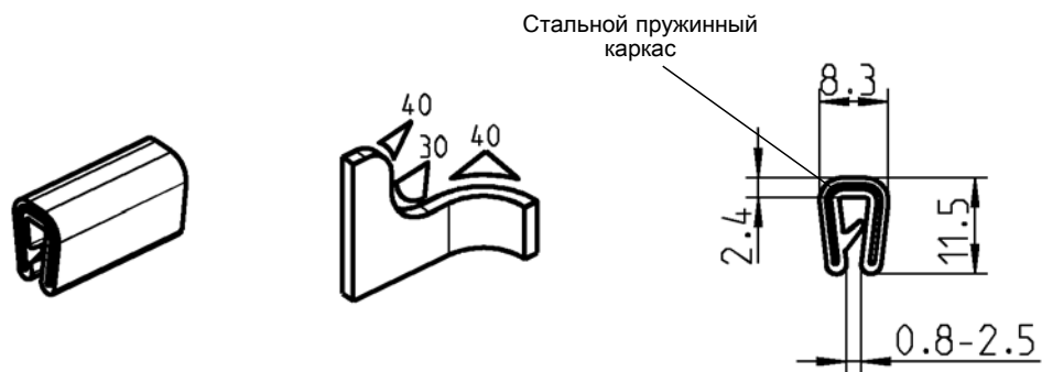
Защита кромки, ЭПДМ 60° ± 5 Shore A черн.
