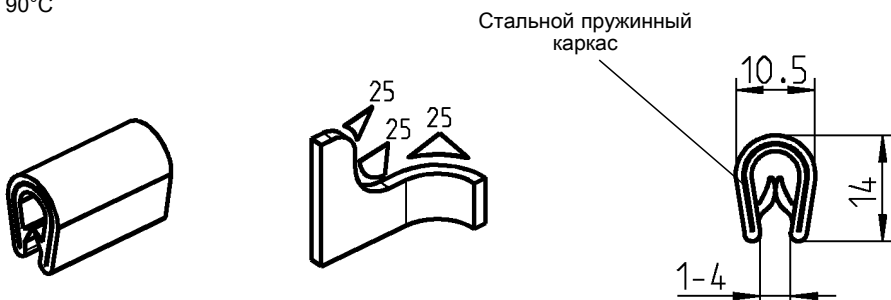
Защита кромки, ПВХ 70° ± 5 Shore A черн.
